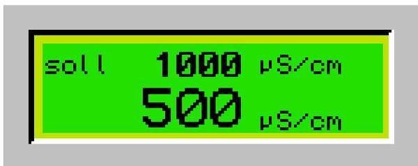
Anzeige des Soll-Wertes für die Leitfähigkeit sowie des Ist-Wertes.
