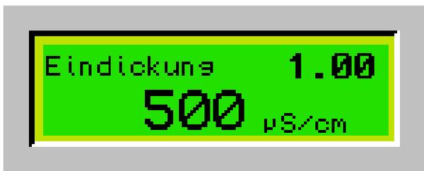
Anzeige des aktuellen Eindickungswertes und aktueller Leitwert. Die Eindickung ist das rechnerische Verhältnis zwischen zufließender Wassermenge und abfließender Wassermenge. Dabei werden nur die Wasserzähler von Nachspeisewasser und Absalzventil berücksichtigt.
